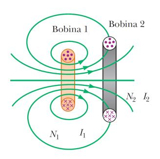
$\phi_{21}=$  flujo que atraviesa una vuelta de la bobina 2, debido al campo de la bobina 1
